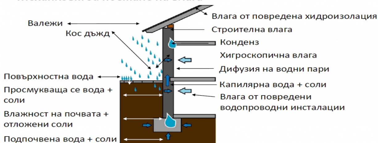
Фиг. 1. Механизъм за поемане на влага
